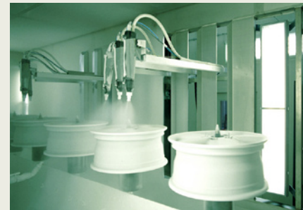
Bild 2: Die Applikation von Grundierpulver erfolgt in der Regel in horizontalen Beschichtungsanlagen. Verwendet werden meist Lacke auf Polyester-Epoxyd-Basis.
