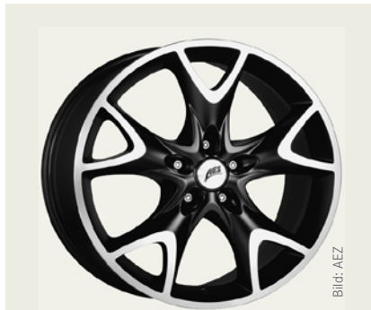
Bild 4: Der attraktive Hell-Dunkel-Kontrast glanzgedrehter Räder wird erzeugt, indem man zuerst schwarz lackiert, dann die betreffenden Stellen bis aufs Metall abdrehet und anschließend mit Klarlack beschichtet
