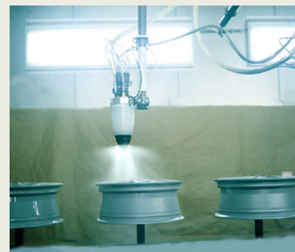
Bild 3: Leichtmetallräder werden für gewöhnlich vollautomatisch beschichtet. Als Basislack eignen sich vor allem Acryl-Melamin-Systeme mit Metallic- und Spezialpigmenten.
