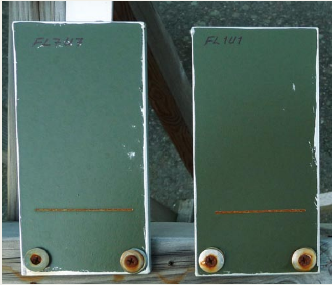
Der wasserverdünnbare Aufbau im Scab-Test nach 2,5 Monaten
