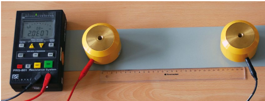
Prüfaufbau zur Messung des Oberflächenwiderstands
