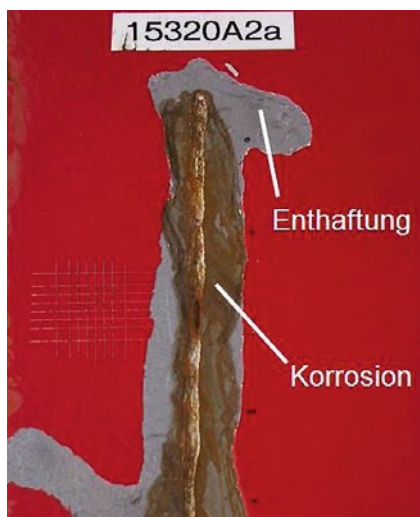
Beurteilung der Korrosion und Enthftung am Ritz nach der Korrosionsschutzprüfung
