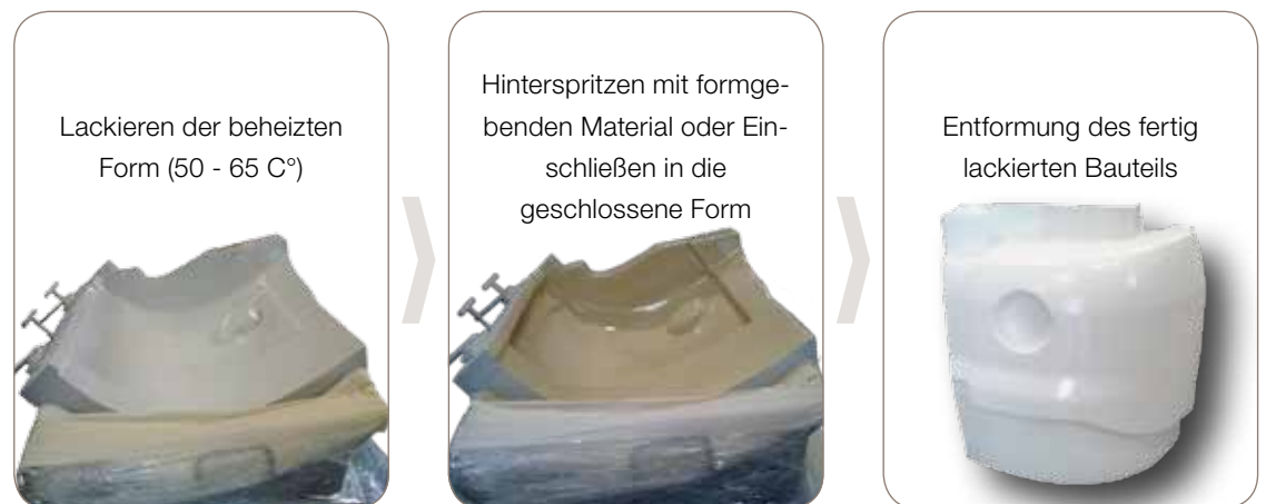
Fertigungssteps beim IMC-Verfahren
