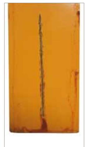
Salzsprühtest des Einschichtsystems nach 500 h Belastung
